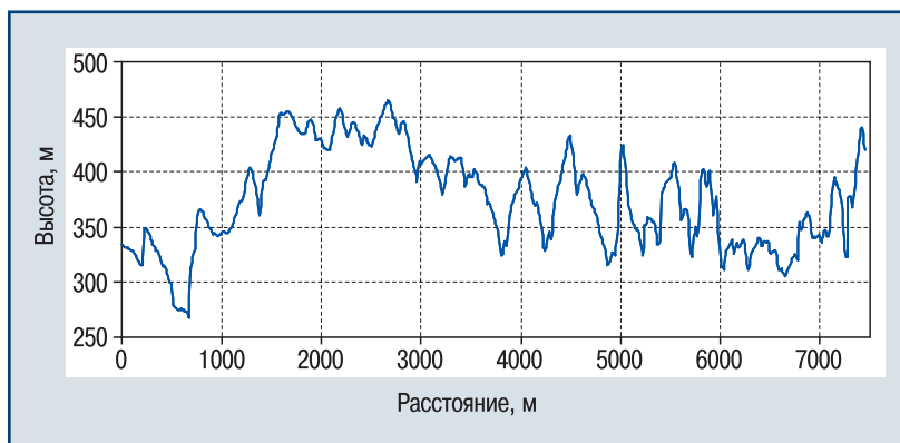
▲ Рис. 2. Высотный профиль трубопровода ▲ Fig. 2. The elevation profile of the pipeline
