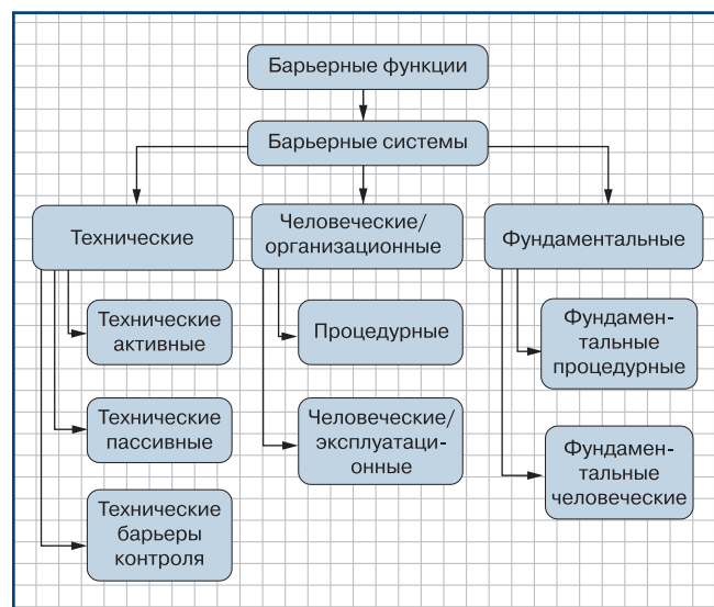
▲ Рис. 4. Классификация барьеров безопасности в соответствии с работой [4]
