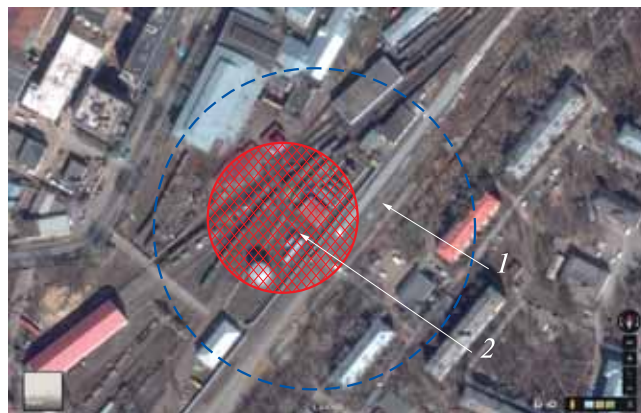
▲ Рис. 4. Область поражения склада ГСМ: 1 — S_{\text{МВКП}} ; 2 — S_{\text{гиб}}
