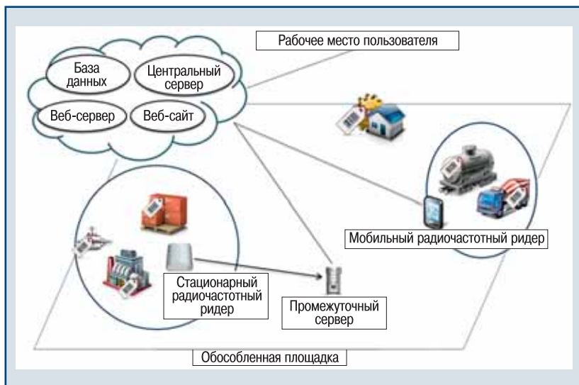
▲ Рис. 1. Схема организации дистанционного контроля за ОПО
